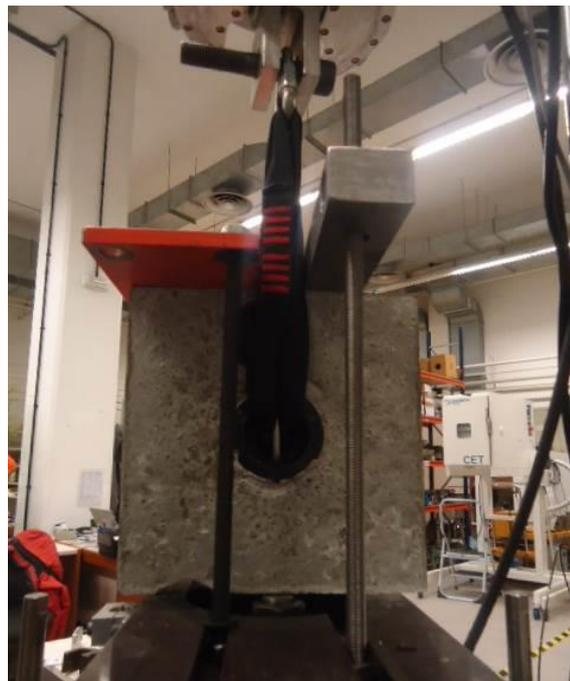
*Imagen 4.* Montaje ensayo introducción de carga posición 2.
