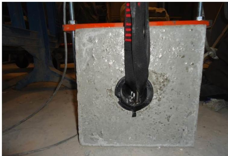
**Imagen 10.** Montaje ensayo introducción de carga posición 2.
