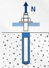
Se produce cuando un anclaje es sometido a una carga a tracción superior a la resistencia del acero. El fallo se produce en la zona roscada, parte del anclaje quedará dentro del agujero de instalación partiendo la varilla roscada en 2 piezas.
