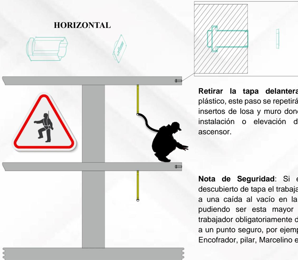
**Retirar la tapa delantera del embebido plástico,** este paso se repetirá por la totalidad de insertos de losa y muro donde se ejecutará la instalación o elevación de las vigas de ascensor.
