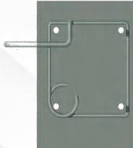
Ubicación del omega en enfierradura de losa.
