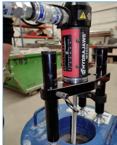
Proceso de fabricación de probetas de hormigón con anclajes PAT50XX/A embutidos
