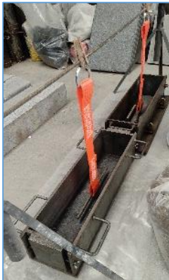
Proceso de fabricación de probetas de hormigón con anclajes PAT50XX/A embutidos
