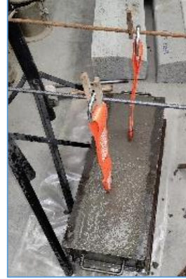
Proceso de fabricación de probetas de hormigón con anclajes PAT50XX/A embutidos
