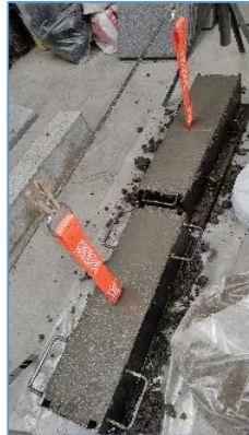
Proceso de fabricación de probetas de hormigón con anclajes PAT50XX/A embutidos
