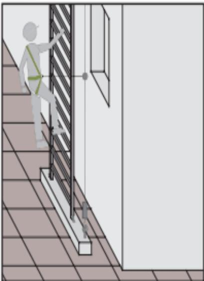
**Línea de seguridad vertical portátil, en cuerda trenzada de poliamida de alta tenacidad termofijada, EN 1891, tipo A + Bloqueador automático no desmontable.**
