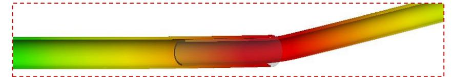
SE OBSERVA QUE EL SOLAPE SE MANTIENE INCLUSO PARA CARGAS DE ROTURA
