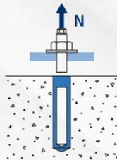
Se produce cuando un anclaje es sometido a una carga a tracción superior a la resistencia del acero. El fallo se produce en la zona roscada, parte del anclaje quedará dentro del agujero de instalación partiendo la varilla roscada en 2 piezas.
