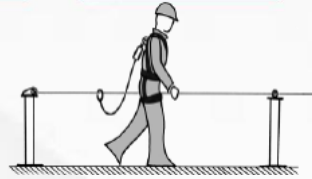
Línea de anclaje flexible horizontal.
